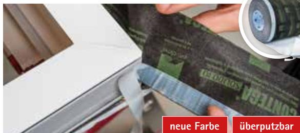
Raumseitig für den dampfbremsenden und luftdichten Anschluss von Bahnen und Holzwerkstoffplatten an Fenster, Türen und mineralische Oberflächen. Außen für den entsprechenden winddichten und schlagregensicheren Anschluss. Die Klebezone auf der Vliesseite ermöglicht einfachere Verklebung an Fenster und Türen bei Verarbeitung vor deren Montage.
