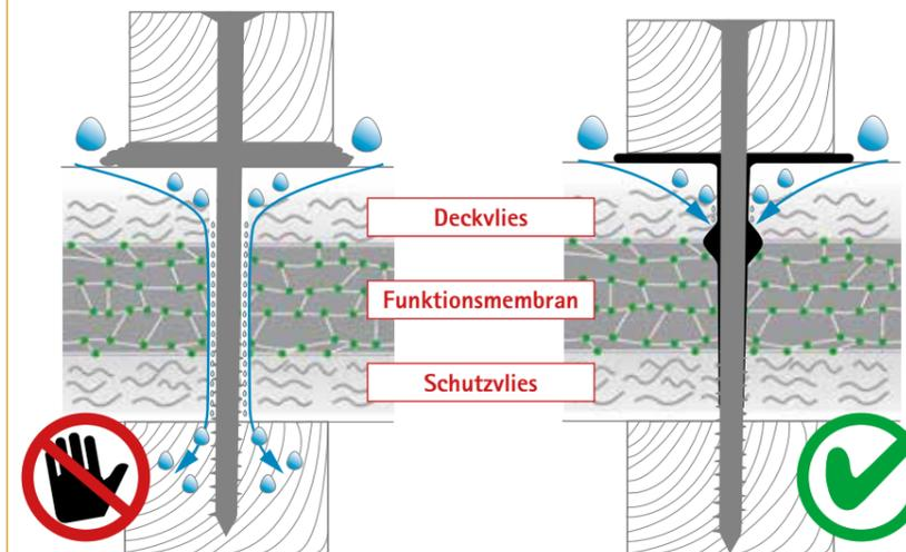
Die Nageldichtung auf Schaumbasis dichtet nur auf dem Vlies ab – Wasser im oberen wasserführenden Vlies kann durch die Durchdringung der Membran eindringen.
