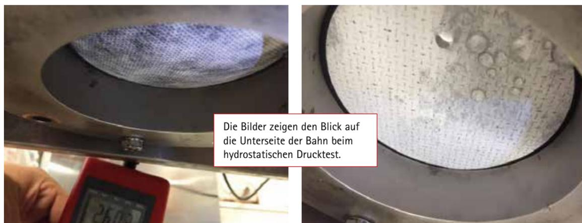
Die Bilder zeigen den Blick auf die Unterseite der Bahn beim hydrostatischen Drucktest.
