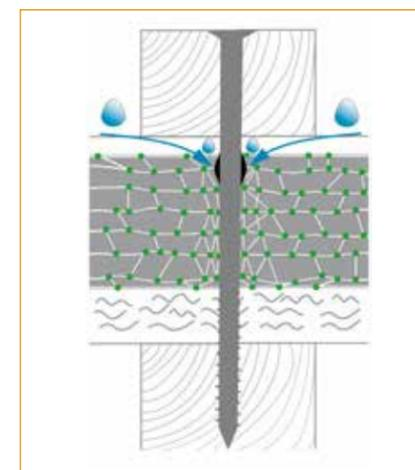
Perforationssicherung durch die dauerhaft
