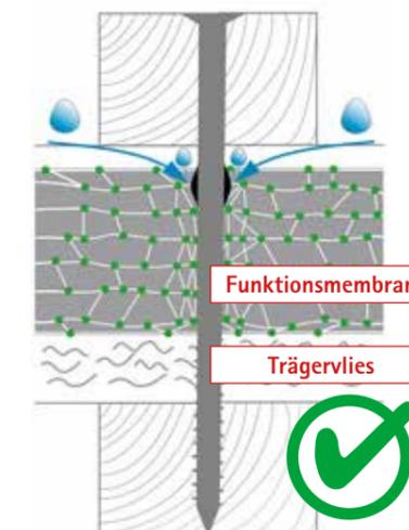
Bei druckfester Unterlage ( $\geq 100$  kPa: Holz-faser-/Holzwerkstoffplatten) dichtet die hohe Elastizität der Funktionsmembran dauerhaft wasserdicht gegen Befestigungsmittel ab.
