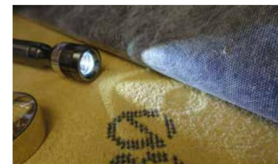
Die darunterliegende Holzfaserplatte hat nach Beschuss mit 50 mm Hagelkörnern eine ca. 4 mm tiefe Delle.
